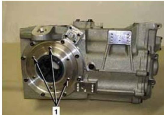
**NOTA:** La réalisation de deux trous taraudés M8 (2), conformément à la figure ci-contre, facilite le démontage du flasque. Respectez impérativement les côtes mentionnées.
