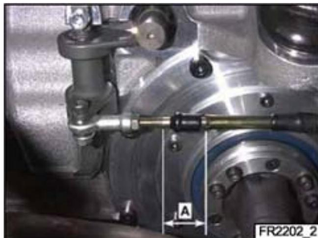
**NOTA:** La pose d'une protection thermique de type fourreau sur le câble est autorisée.
