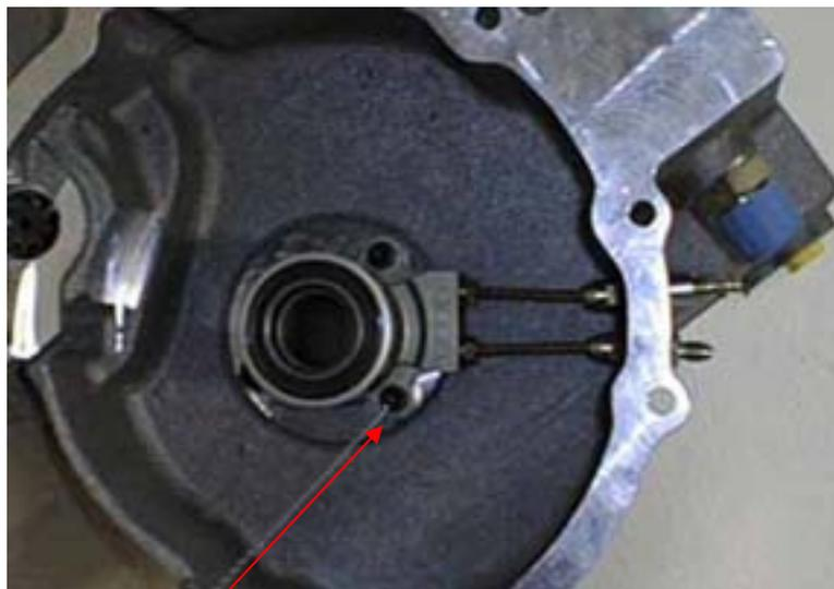
Vis butée hydraulique : 22N.m
